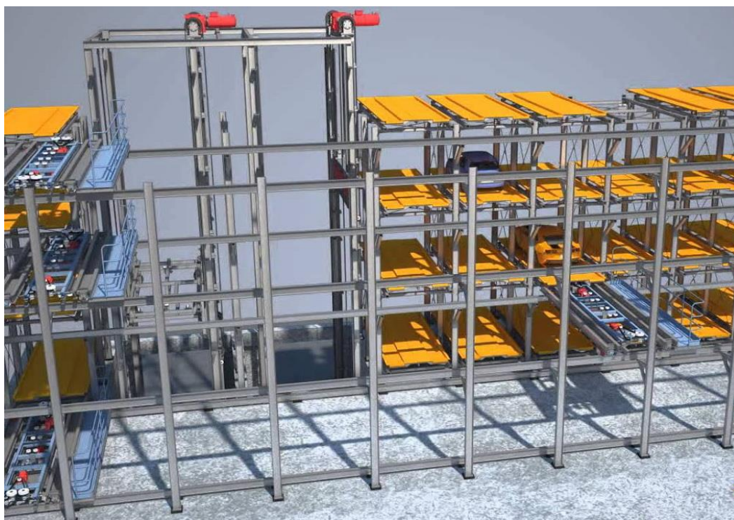
Стеллажный паркинг с двухкоординатными платформами манипуляторами. Общий вид.
