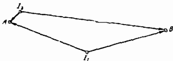
Рис. 132. Проверка постоянства положения визирной оси трубы нивелира
