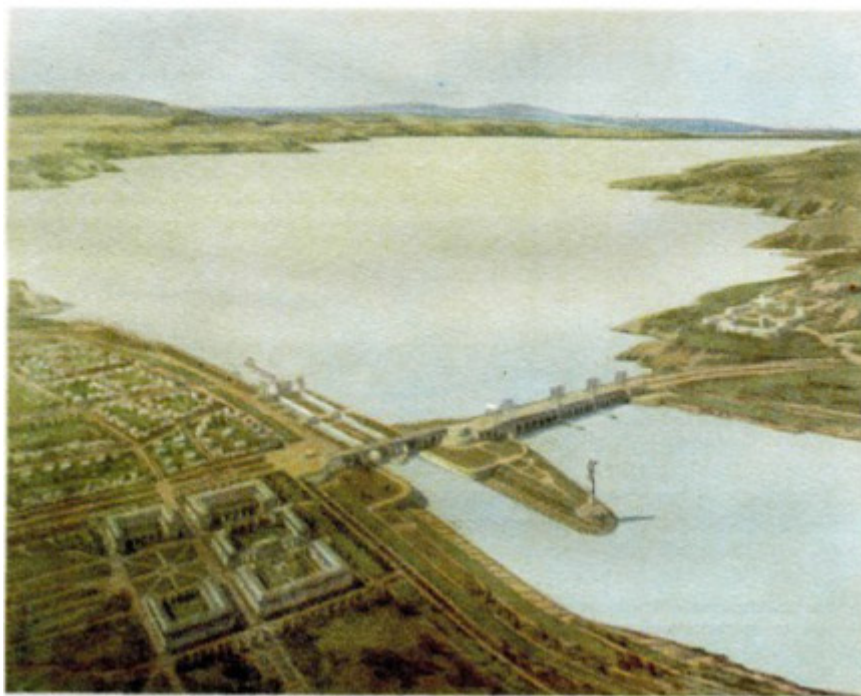
Рис. 124. Приемы изображения панорамы гидроузла. При высоком горизонте перспективные планы создаются при помощи линейной и воздушной перспектив с равномерным освещением всего пространства.
