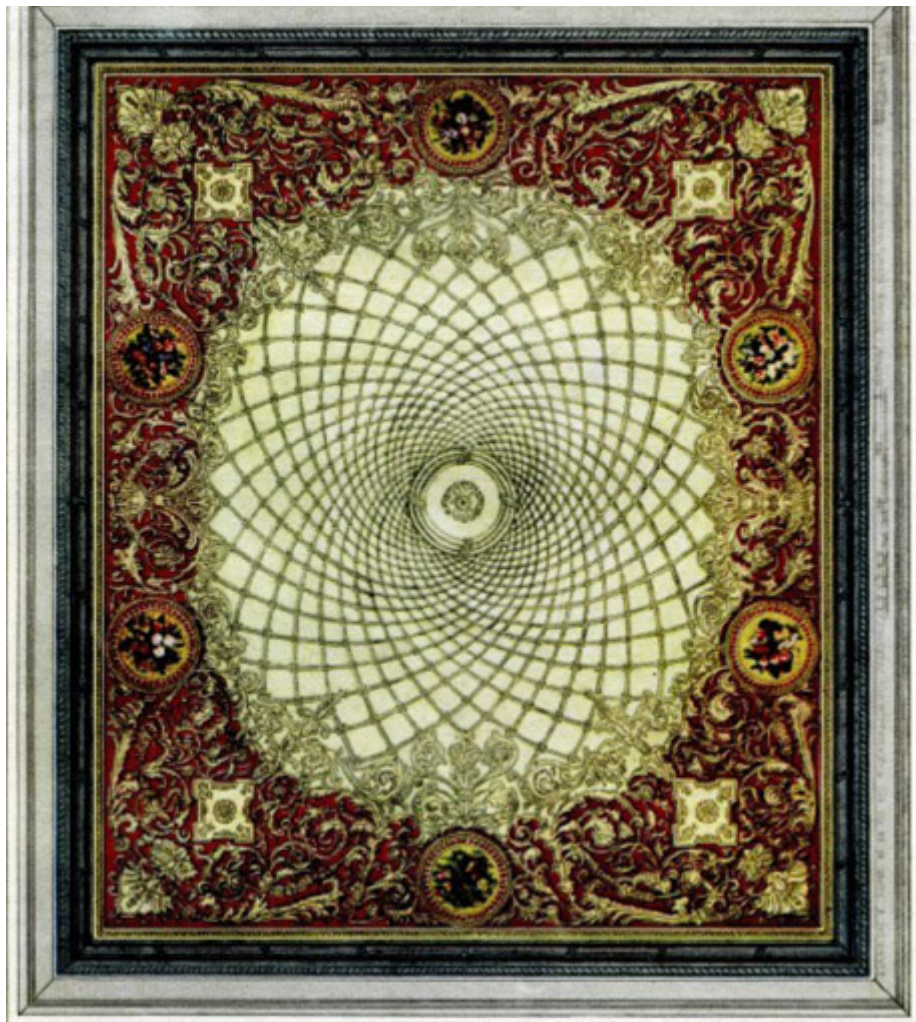
Рис. 72. Монохромный прием обработки плафона. Плафон бывш. дома Найденовых в Москве. Рисунок архитектора Н. Я. Тамонькина. Плафон написан гризайлью и имеет общий с рельефным карнизом скульптурный светотеневой характер.
